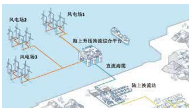
图6 基于模块化海上升压换流综合平台的HVDC风电送出示意图
